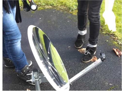
Les résultats sont très prometteurs car la parabole miroir permet une augmentation de 750%. Mais en faisant la mesure, le luxmètre a tellement reçu d'énergie qu'il s'est mis à fumer. Aussi, il est devenu évident que la suite du projet devait être encadrée par des spécialistes, en l'occurrence, les professeurs universitaires du laboratoire de génie civil de la faculté des sciences appliquées de Béthune.
