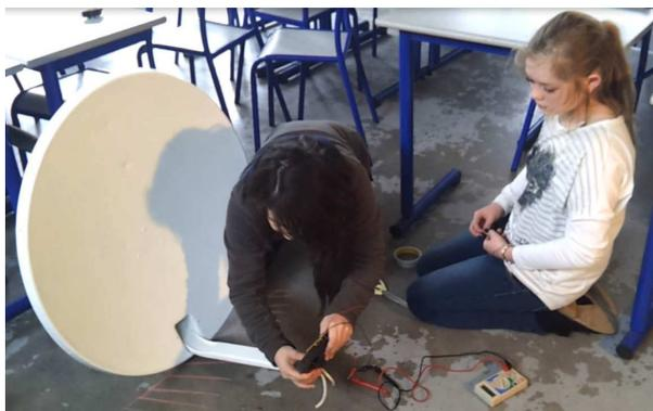
Après avoir peint la surface de la parabole avec la couleur la plus réfléchissante, le blanc brillant, nous avons souhaité vérifier si le système fonctionnait. Cette couleur réfléchit 52% de la lumière. Si notre système fonctionne, la parabole renverra donc 52% de la lumière reçue sur sa surface. Cette surface étant beaucoup plus grande que celle du panneau solaire, la
