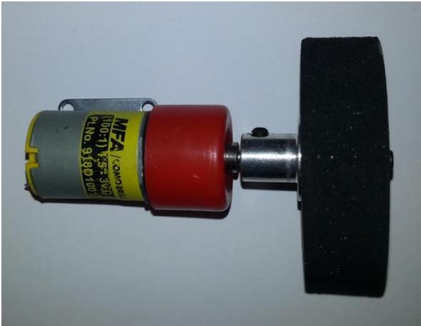
Pour rendre notre robot mobile, nous l'avons équipé de deux motoréducteurs, chacun composé d'un moteur 3V à courant continu, couplé à une roue en néoprène.
